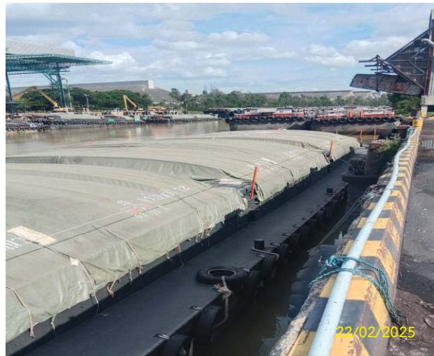
ญ) การคลุมผ้าใบเรือลำเลียงสินค้าระหว่างการขนส่ง และการตรวจสอบสภาพ
